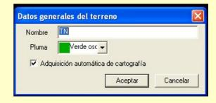
Además se permite marcar la casilla de adquisición automática cuando la opción que seleccionamos para dicha adquisición es mediante "Cartografía perfil".
