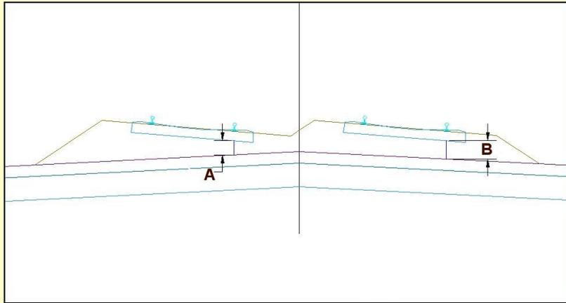
En la imagen anterior, el mínimo espesor bajo traviesa está situado bajo el carril derecho de la vía izquierda. Así que si el entreaje izquierdo fuera 0 (no se dibuja la vía ni balasto de la izquierda) y se **activa** el parámetro **Primera fase**, el espesor bajo traviesa de la vía derecha sería **B** que resultaría mayor que el mínimo estricto.
