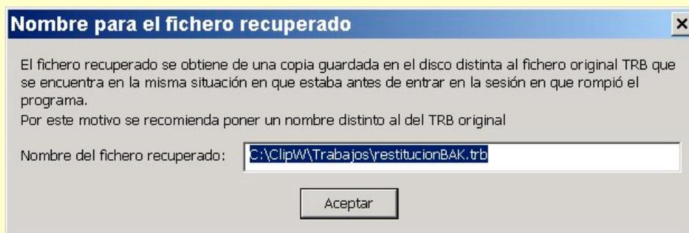
Se informa que la información actualmente abierta puede ser diferente a la almacenada en el fichero TRB original (el de inicio de la sesión de trabajo), por lo que resulta útil guardar dicha información con otro nombre por si se desea comprobar la diferencia entre ambos ficheros. Se propone guardar la información a un TRB con el mismo nombre que el original mas las letras BAK para distinguirlo de aquel.
